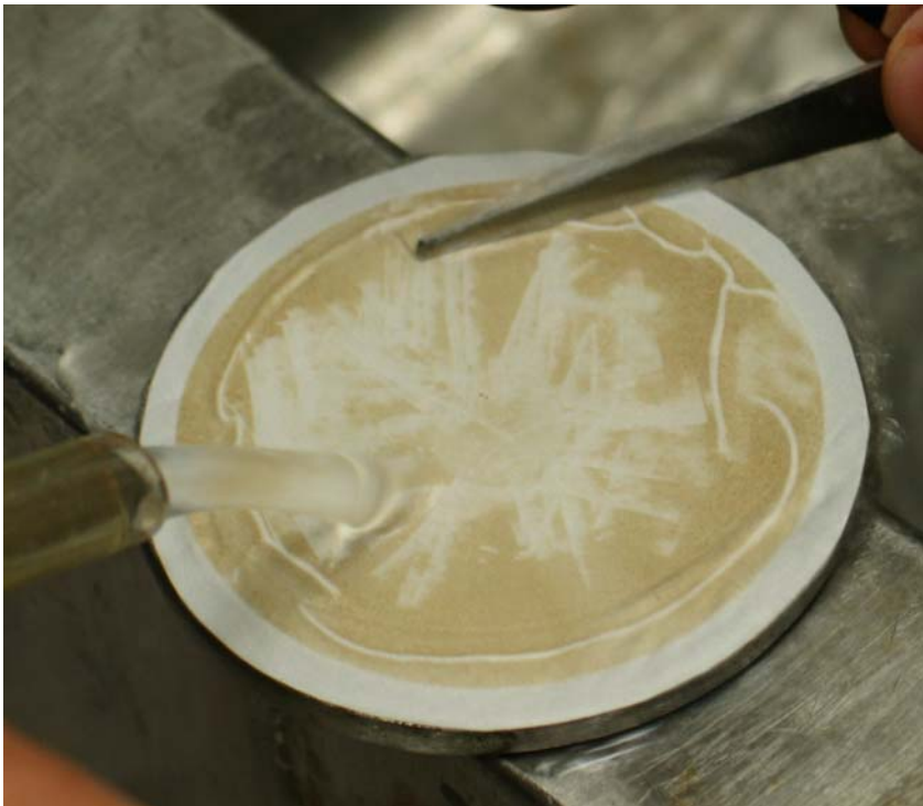
(d) Gentle scraping with a blade
