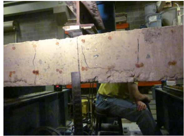
e) Final DEMEC Reading ( 16.7 kipft)
