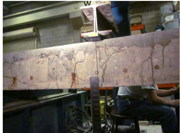
e) Final DEMEC Reading (17.3 kipft)
